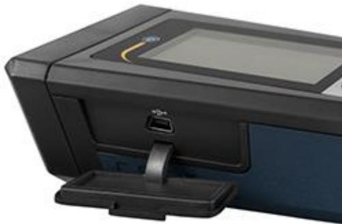
Puede transferir de forma continua los datos a través del puerto USB del anemómetro
